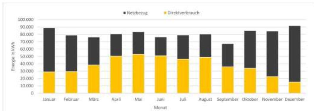
Abbildung 13: Simulation Istzustand Ortsnetz Dörpum (Höck, 2018)
