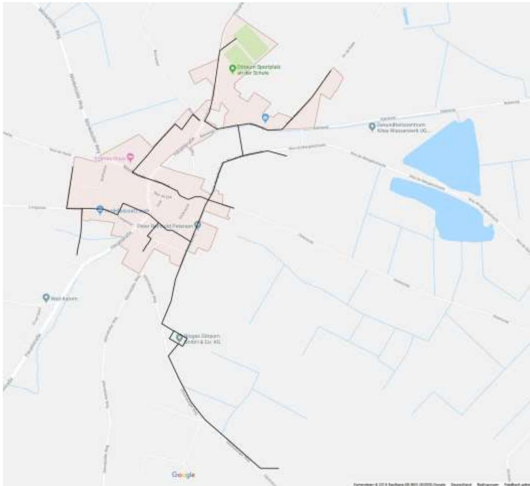
Abbildung 6: Wärmenetz im Bestand des Quartier Dörpum
